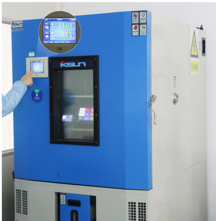
图 5-8 高低温老化测试图
